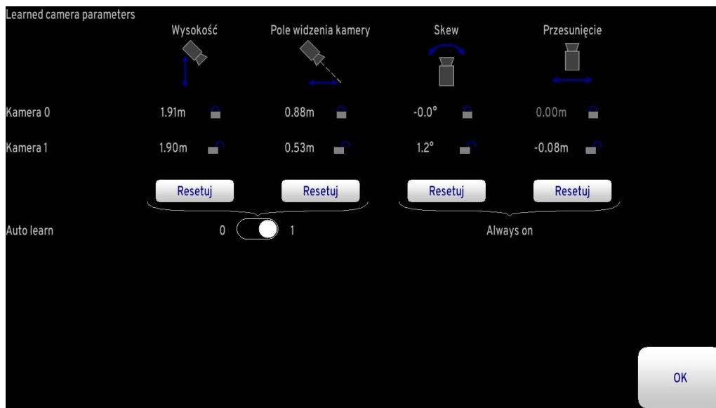
Ekran z parametrami kamery z włączoną funkcją „Auto uczenie”
