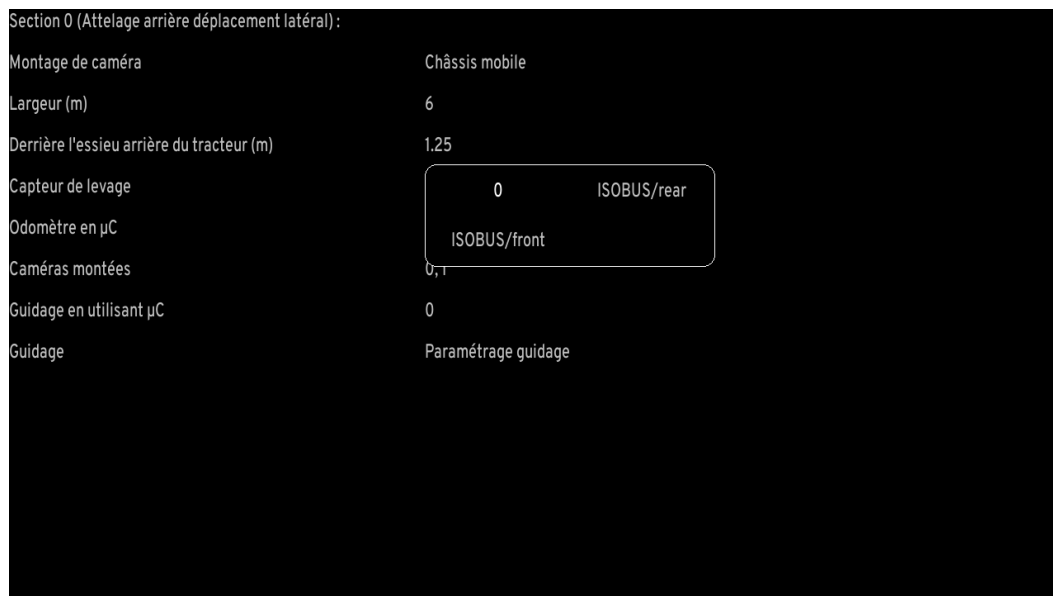
Sélection de la source d'entrée de levage dans l'écran de l'éditeur avancé de la « Section » de configuration
