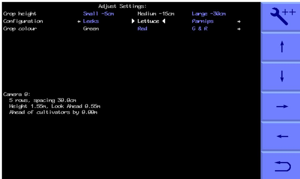
**“Crop size” (Pflanzen höhe)** vergrößert die Vorlage, um die Annäherung des Erntebestands an die Kamera während des Wachstums auszugleichen, ohne dass die Höhe der Kamera mechanisch angepasst werden muss. Als Anhaltspunkt gilt, dass Pflanzen bis zu einer Höhe von etwa 5 cm als klein, 5 cm bis 15 cm als mittel und mehr als 15 cm als groß angesehen werden. Stellen Sie sicher, dass vor Arbeitsbeginn eine passende Pflanzengröße ausgewählt wird.
