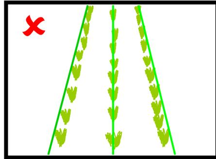
Wenn die Vorlage in der Mitte des Bildes übereinstimmt, aber oben oder unten abweicht, überprüfen Sie, ob das Arbeitsgerät waagrecht ist. Wenn es bereits waagrecht ist, muss der Neigungswinkel der Kamera möglicherweise justiert werden.
